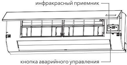
При нажатии кнопки аварийного управления фанкойл будет включаться в следующих режимах: Авто — Быстрое охлаждение — Выключен — Авто.
