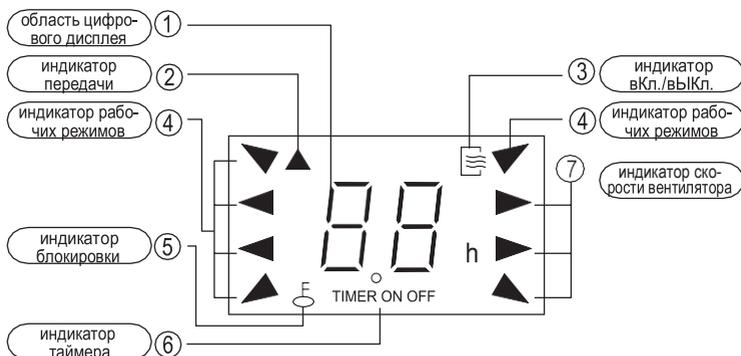
1. **Область цифрового дисплея** – в данной части дисплея вы сможете увидеть заданную температуру, а если сейчас используется таймер, то вы также увидите, какой таймер сейчас работает (включения или выключения), и оставшееся время до активации функции таймера.
